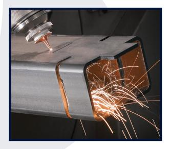
PRECITEC LIGHTCUTTER 3D CUTTING HEAD
